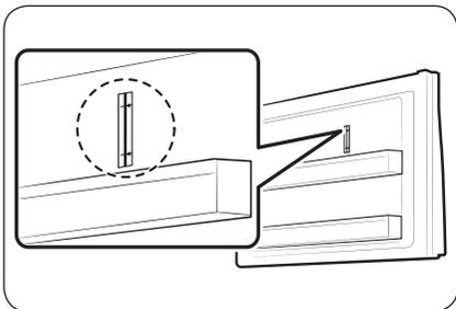
Холодильник оснащен индикатором предельной нагрузки, который расположен в верхней правой стороне морозильной камеры.
