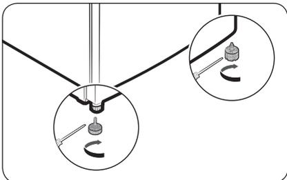
Выравнивайте холодильник, вручную отрегулировав ножки. Для уменьшения высоты поверните ножки по часовой стрелке, а для увеличения – против часовой стрелки. По соображениям безопасности переднюю сторону следует сделать немного выше задней.
