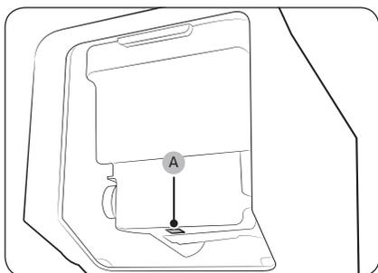
Если автоматический льдогенератор не производит лед, снимите ведерко и нажмите кнопку **Проверка (A)**, чтобы проверить правильность его работы.
