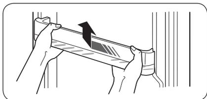
Слегка приподнимите и извлеките дверной лоток.
