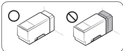
3. Вставьте обратно резервуар и установите его в механизм диспенсера. Убедитесь, что передняя сторона (с передней заслонкой) резервуара направлена в вашу сторону.
