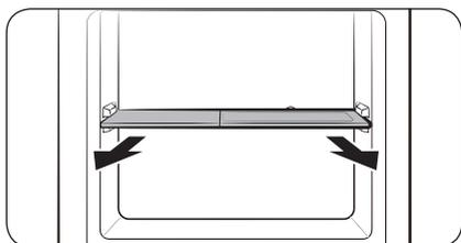
Сначала снимите лоток для льда, после чего приподнимите полку морозильной камеры и снимите ее.
