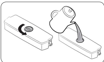
2. Suv idishini 2,3 litrgacha bo'lgan ichimlik suvi bilan to'ldiring. Suvdonning tepa qopqoqchasi yoki butun qopqog'ini chiqarib oling va unga suv qo'ying.
