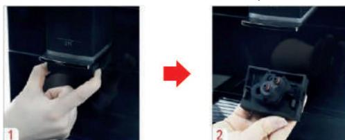
**3-й крок:** Розберіть блок видачі кави, блок спінювання молока, з'єднувач та інші компоненти, промийте їх під проточною водою.
