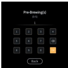
Час попереднього просочування кавового порошку, одиниця вимірювання: с, варіанти налаштування: 0~5.
