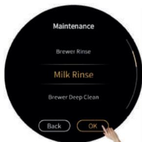
**4-й крок:** Відбувається вхід до режиму швидкого промивання контуру молока. Натисніть **OK** для швидкого промивання контуру молока.
