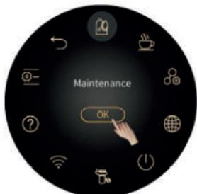
**3-й крок:** Перейдіть з центру екрана на глибоке промивання блока заварювання. Натисніть **OK**.
