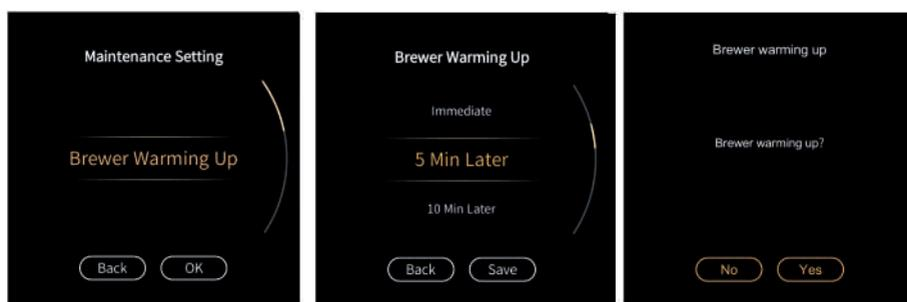
Встановлення активації функції прогрівання блока заварювання. Можливість встановлення умови активації функції **"Brewer Warming Up"** ("Прогрівання блока заварювання").
