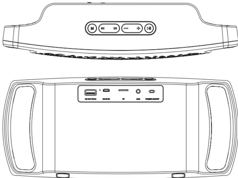
**AUX** - аудиоразъем 3,5мм для подключения дополнительного источника звука.
