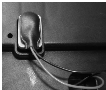
9 В блочна батарея для аварійного опускання (головний двигун)
