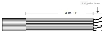
Рисунок 32: Зняття ізоляції – змінний струм
