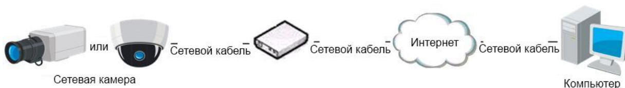
Рисунок 2-6 Доступ к видеокamере с динамическим IP адресом
