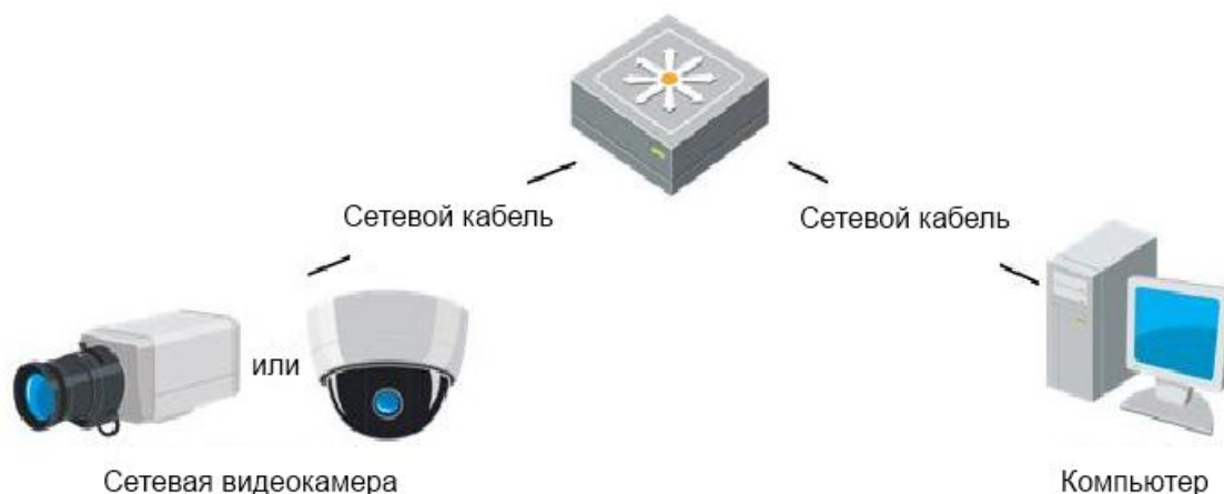
Рисунок 2-2 Подключение через коммутатор или роутер
