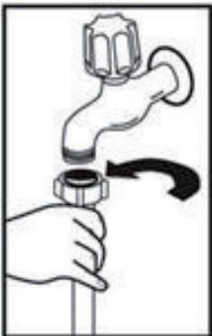
непосредственно к водопроводному крану. Давление воды на входе должно составлять не менее 0,03 МПа, а максимально 1 МПа. Если давление воды превышает 1 МПа, то перед посудомоечной машиной необходимо установить спускной клапан для предотвращения чрезмерного повышения давления.
