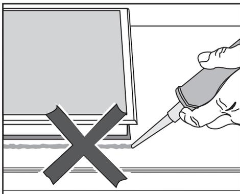
При необходимости демонтажа панель конфорок и столешница могут быть повреждены, если вокруг панели имеется герметик. Не используйте герметики между панелью конфорок и столешницей. Уплотнение под краем верхней части прибора обеспечивает достаточную герметичность между прибором и столешницей.
