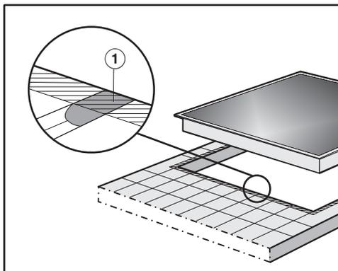
Стыки ① и заштрихованная область под поверхностью панели конфорок должны быть гладкими и ровными, чтобы панель лежала ровно и уплотнение под кромкой верхней части прибора обеспечивало герметизацию столешницы.
